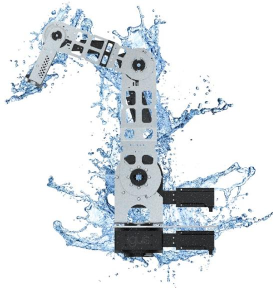
このロボリンクは、保護等級 IP44 を満たしているため水しぶきがかかる環境に適しています。また、保護等級 IP65 のエンコーダ付きモーターを使用しているため、屋外での検査等にも使用できます。その他、食品・飲料業界、化学・製薬業界、タンクやコンテナの洗浄作業などの用途にも適用可能です。
